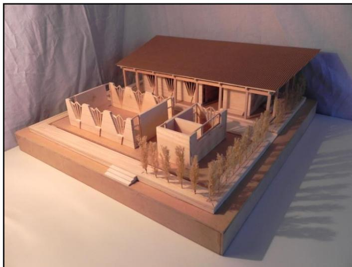
L'edificio avrà una forma e un orientamento che cercano di ottimizzare la ventilazione naturale di 4 classi. In tutte le fasi di costruzione è previsto il coinvolgimento della comunità nella esecuzione dei lavori edili.
